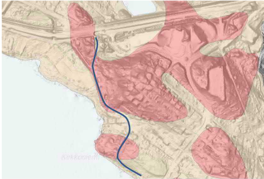
Kuva: Kellotornintien alue on maaperältään kalliolta ja hiekkamoreenia. / GTK
